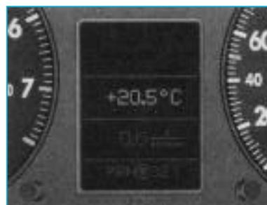
global de contrôle. Sur les véhicules à boîte de vitesses automatique, la température extérieure n'est affichée sur le visuel que lorsque l'on a engagé une gamme de vitesse.
