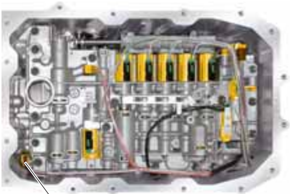
Connecteur de transmetteur de régime d'entrée de boîte de vitesses G182
