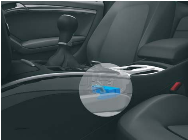
Implantation de l'antenne R138 dans la console centrale 393_015
