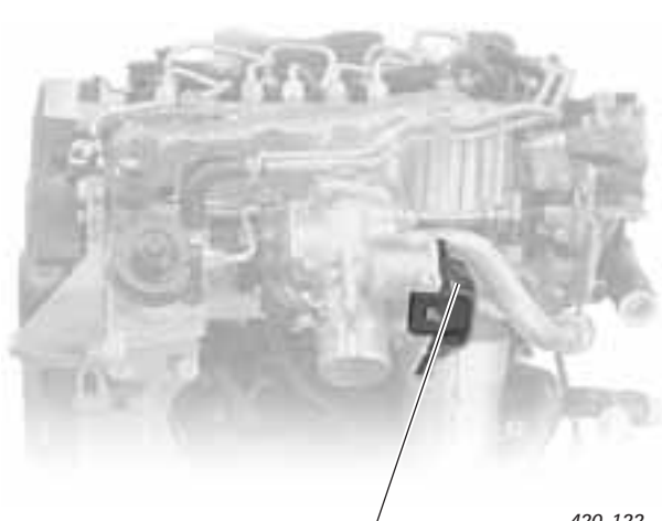
Potentiomètre de papillon G69
