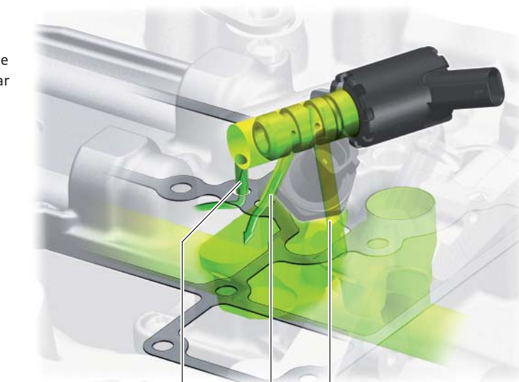
Pression d'huile en provenance de la galerie d'huile principale
