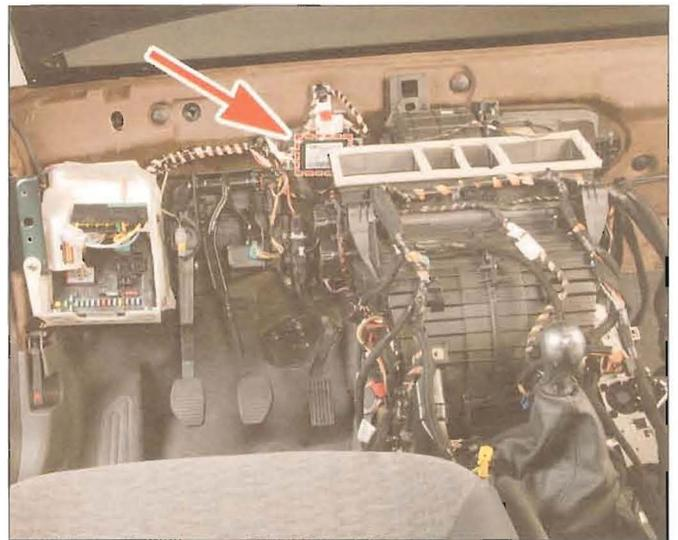
SITUATION DU CALCULATEUR D'ADDITIF DE CARBURANT (implanté derrière la planche de bord mais accessible après simple dépose du combiné d'instruments).
