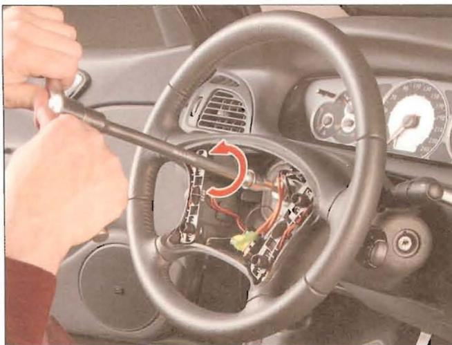
**Nota :** Le moyeu du volant comporte une flèche (placée à 12 heures) qui doit être alignée, à la repose, avec le repère (trait de scie) sur la colonne. Cet alignement est de toute façon imposé par la présence d'un méplat n'offrant qu'une seule et unique position de montage.
