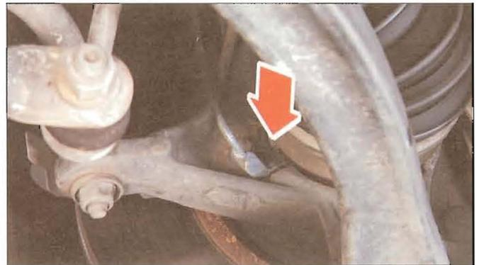
IMPLANTATION D'UN CAPTEUR DE ROUE AVANT
