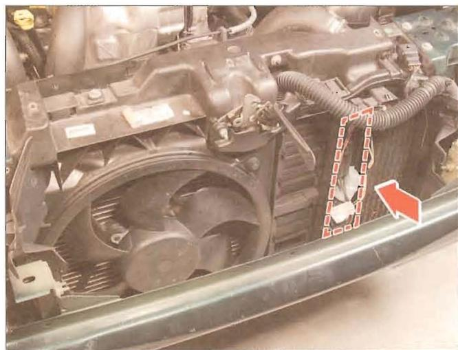
**IMPLANTATION DU MOTOVENTILATEUR ET DU HACHEUR ÉLECTRONIQUE.**
