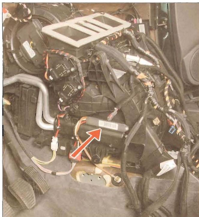
**IMPLANTATION DU MODULE DE CHAUFFAGE ADDITIONNEL DANS LE BOÎTIER DE CHAUFFAGE**
