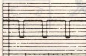
Coupure d'une diode excitatrice
