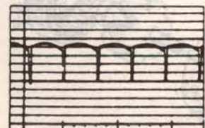
Défaut de phase (bobinage de stator en court-circuit ou interrompu)
