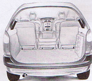
Le siège arrière central peut être rabattu pour servir d'accoudoirs et de tablette aux occupants des sièges arrière latéraux.
