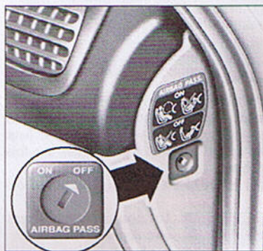
Interrupteur de neutralisation de l'airbag passager frontal.
