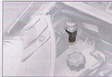
Localisation du contacteur à inertie pour réarmer le circuit d'alimentation en carburant.
