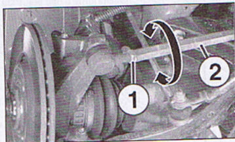
Réglage du parallélisme. 1. Contre-écrou de la biellette de direction - 2. Manchon de réglage.
