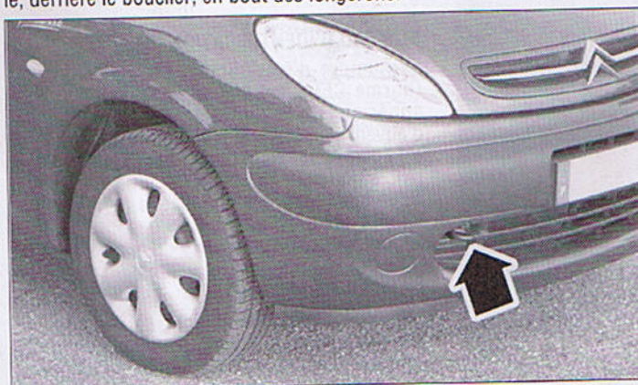
Remorquage à l'avant.
