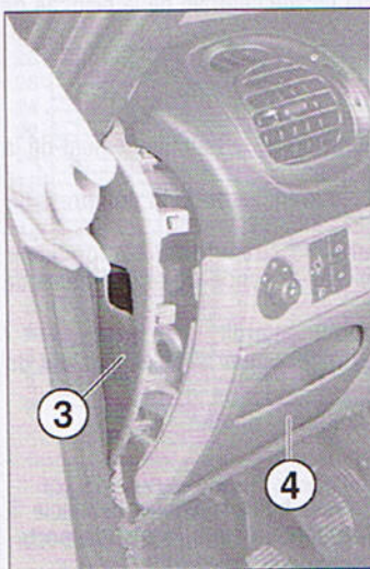
Dépose de la garniture latérale gauche et du couvercle de la boîte à fusibles.
