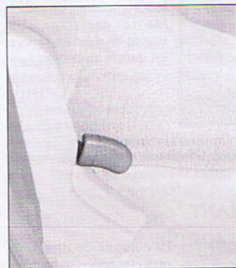
Emplacement du levier pour incliner ou rabattre le dossier du siège arrière.
