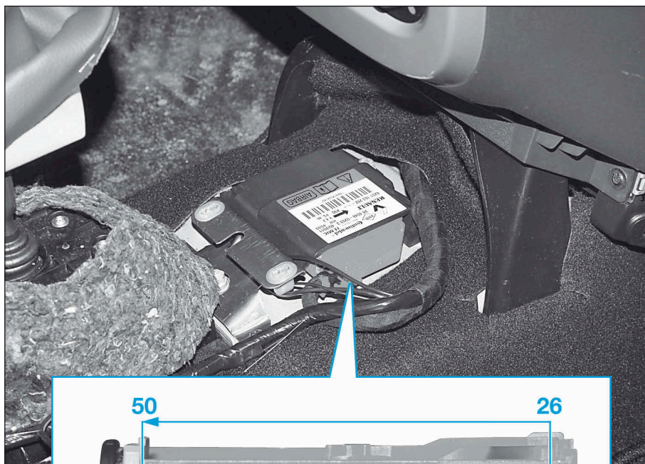
IMPLANTATION DU CALCULATEUR D'AIRBAG ET BROCHAGE DE SON CONNECTEUR
