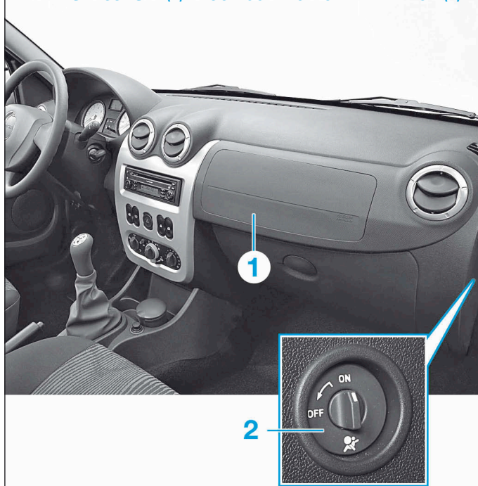
AIRBAG PASSAGER (1) ET SON CONTACTEUR D'INHIBITION (2)
