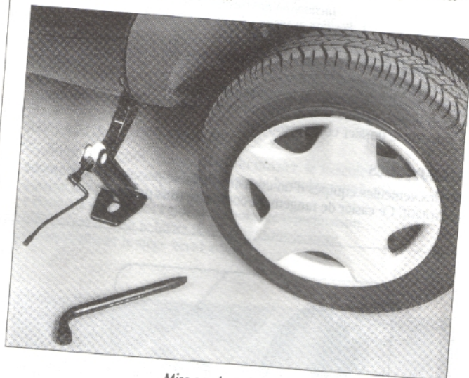
Mise en place du cric.
