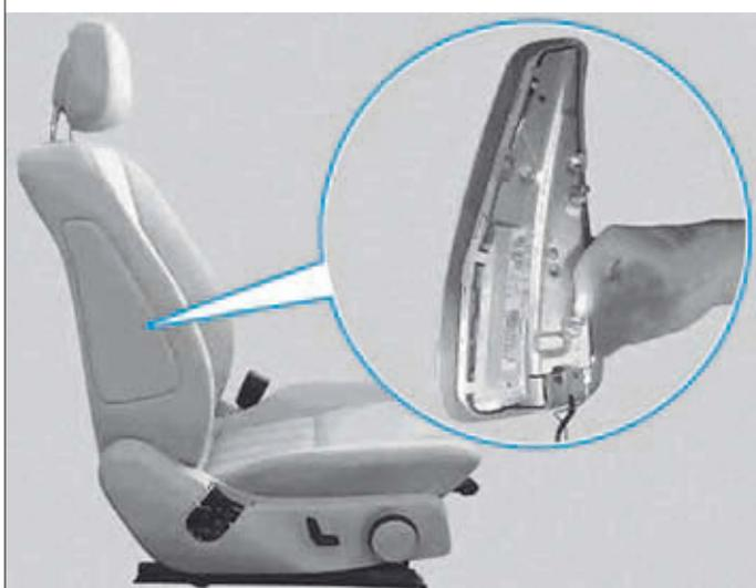
L'airbag latéral se déploie du côté d'où provient le signal envoyé par le capteur de choc latéral. Lors de son déploiement, la couture de la housse de siège se déchire, laissant l'airbag sortir librement du dossier du siège. Il est donc interdit de poser des housses de sièges adaptables.
