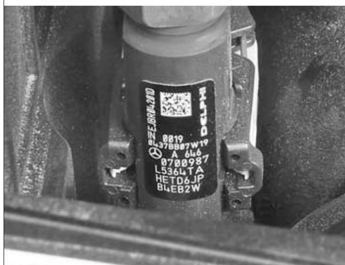
Résistance mesurée entre les voies 25-74 (injecteur 1), 2-49 (injecteur 2), 1-73 (injecteur 3) ou 26-51 (injecteur 4) du connecteur 96 voies : 0,4 Ω.
