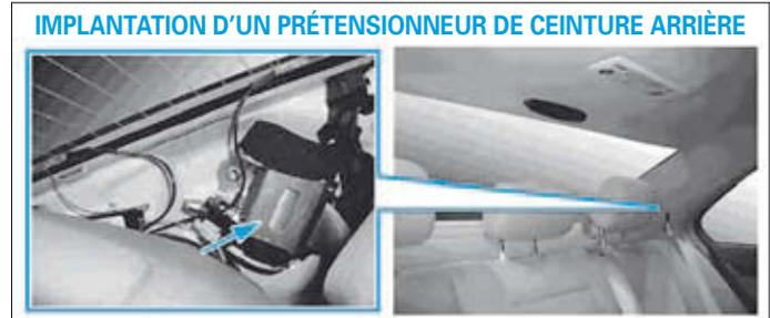
La mise à feu d'un prétenseur entraîne le remplacement de la ceinture de sécurité.
