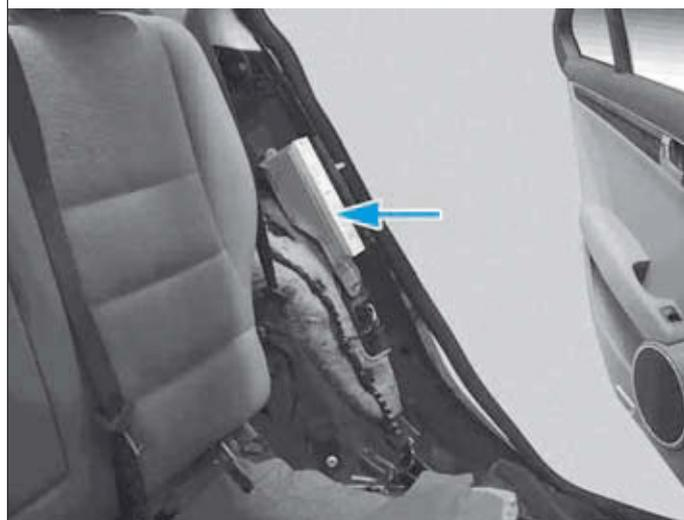
La mise à feu de l'airbag latéral arrière entraîne le remplacement de la garniture du pied arrière.
