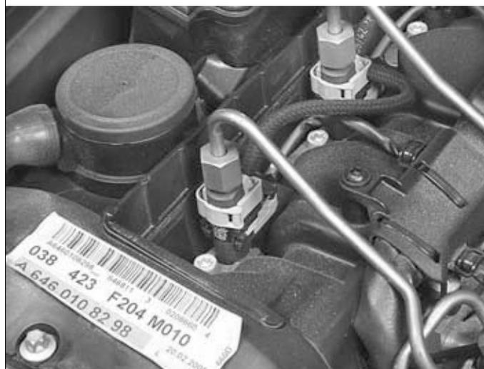
Tous les injecteurs possèdent un codage, le Delphi I3C (Improved Individual Injection Correction), qui se trouve au niveau de l'induit. Ce codage décrit la caractéristique de débit de l'injecteur. En cas de remplacement d'un injecteur, ce codage doit être communiqué au calculateur d'injection au moyen d'un outil de diagnostic.
