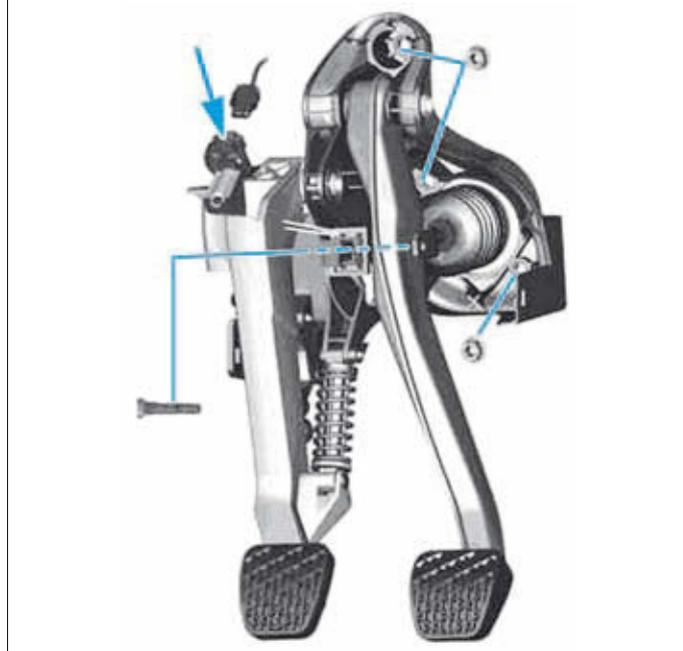
Résistance mesurée entre la voie 27 du connecteur à 58 voies et la masse (pédale relâchée / enfoncée) : ∞ / 0,5 Ω.
