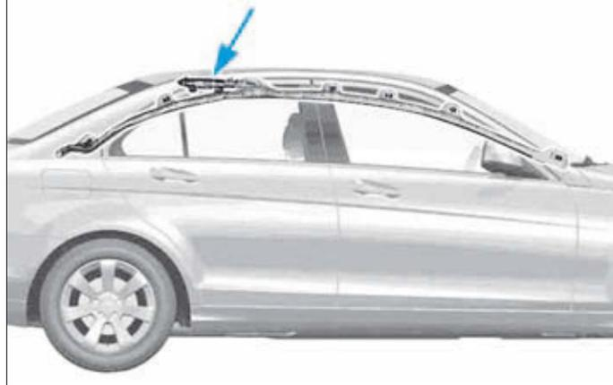
La mise à feu de l'airbag rideau entraîne le remplacement de la garniture de pavillon, des guides de l'airbag, des supports des poignées de maintien ainsi que du revêtement des montants de pied avant, milieu et arrière.
