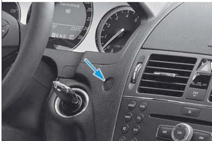
Résistance de la sonde de température d'air habitacle mesurée entre les voies 6 et 15 du connecteur 16 voies : 12,2 kΩ à 21 °C.
