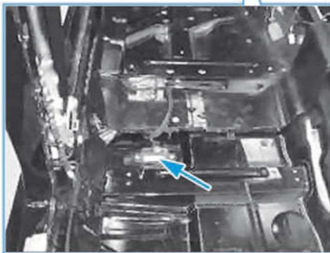
**CAPTEUR D'ACCÉLÉRATION TRANSVERSALE, DE LACET ET D'ACCÉLÉRATION LONGITUDINALE (B24/15)**
