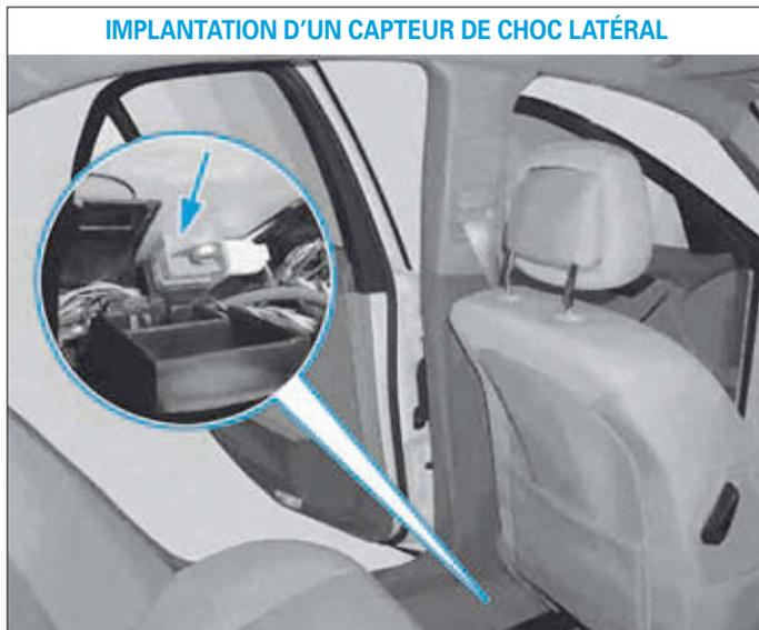
La mise à feu des airbags latéraux entraîne, du côté concerné, le remplacement du capteur de choc latéral.
