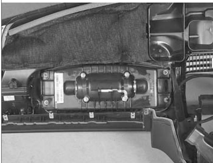
Après le déclenchement de l'airbag passager, remplacer la planche de bord et vérifier l'état des supports de l'airbag et les remplacer si nécessaire.
