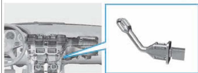
Résistance de la sonde de température de l'évaporateur mesurée entre les voies 12 et 13 du connecteur 14 voies : 3,6 kΩ à 21 °C.
