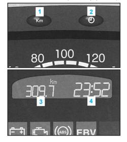
Affichage à la place du kilométrage, de l'heure et de la température extérieure du message «Départ erreur» : présence d'un défaut. Couper et remettre le contact. Si le message réapparaît, faire éliminer la cause du défaut par un point de service Mercedes-Benz.
