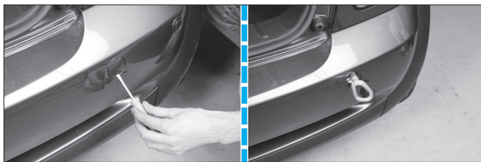
IMPLANTATION DU CROCHET DE REMORQUAGE ARRIÈRE (Mini Cooper.S)
