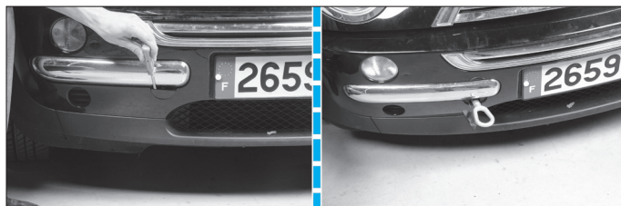
IMPLANTATION DU CROCHET DE REMORQUAGE ARRIÈRE (Mini One et Cooper)
