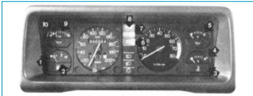
**1 : Témoin de réserve de carburant, à deux seuils (pré-alerte et alerte).** — Le voyant s'allume par intermittence, le niveau de carburant est inférieur à 11 l.
