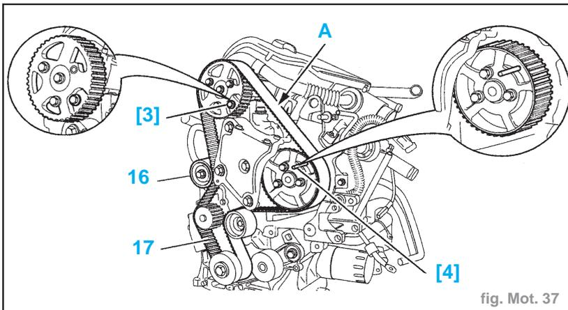
**Impératif :** Vérifier que les galets (16) et (18) tournent librement (absence de point dur), vérifier également que ces galets ne sont pas bruyants et/ou qu'ils ne présentent pas de projections de graisse (fig. Mot. 38).
