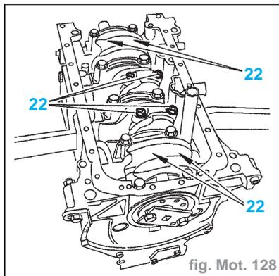
**Impératif** : Lors du remontage des chapeaux de bielles, ne pas réutiliser les écrous montés d'origine, mais des écrous neufs.
