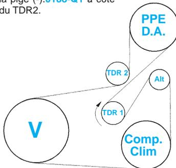
**Attention** : Le déplacement angulaire (a) de la poulie par rapport à la courroie ne doit pas être supérieur à la largeur d'une dent.
