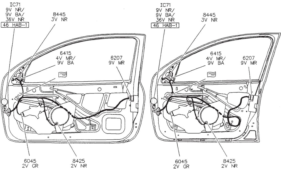
FAISCEAUX PORTES ARRIÈRE GAUCHE ET DROITE
