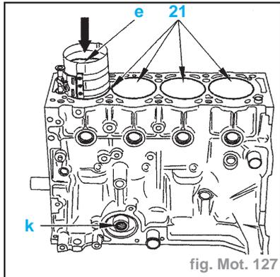
**Impératif** : Orienter le trèfle "e" côté filtre à huile "k". Respecter l'appariement bielles/cylindres.
