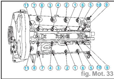
**Impératif** : Procéder vis par vis et dans l'ordre indiqué (ordre 1 à 11) (fig. Mot. 33).
