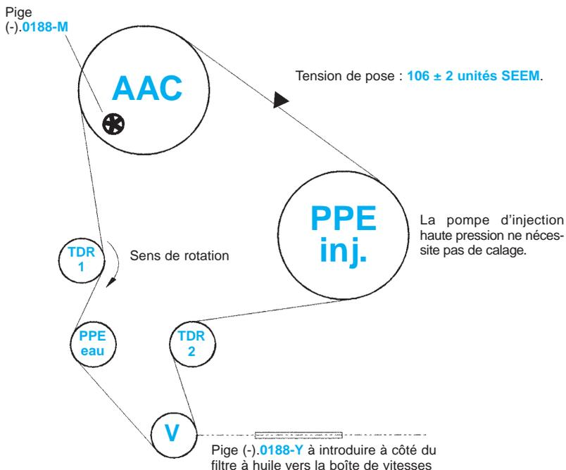
**Impératif** : En déposant une vis (12) sur la poulie (13), s'assurer que ces vis (12) ne sont pas en butée de boutonnière. Dans le cas contraire, reprendre l'opération de repose de la courroie de distribution.
