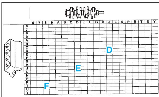
**Nota** : Les paliers de vilebrequin sont repérés de **1** à **5**, le N°1 côté volant moteur.
