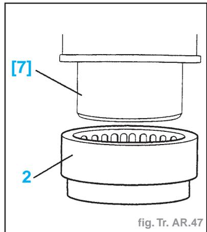
**La douille à aiguille (côté intérieur)**
