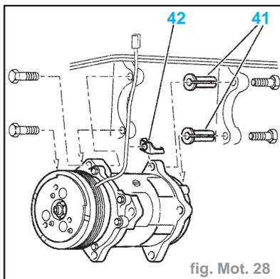
**Attention** : L'écrou anti-rotation (42) fixe le compresseur en partie arrière supérieure.
