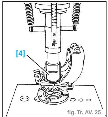
**Nota** : S'assurer de la présence de la bague de plastique de maintien des cages intérieures de roulement. Cette bague ne doit jamais être déposée préalablement à la main, elle sera chassée par le moyeu lors de sa mise en place.
