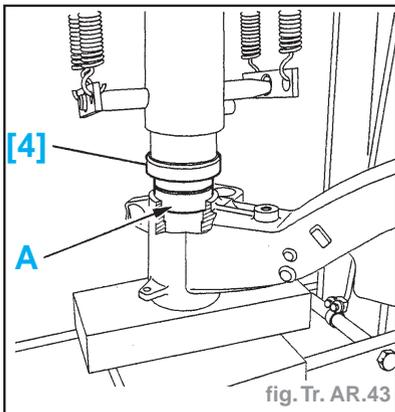
**La douille à aiguille (côté intérieur)**
