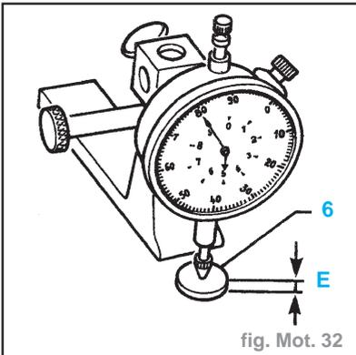
**Attention** : Après une intervention sur la culasse (échange arbre à cames, poussoirs, soupapes ou rodage soupapes), monter des grains de réglage (**6**) d'épaisseur **E = 2,425 mm**.
