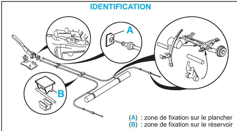
(A) : zone de fixation sur le plancher
