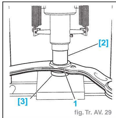
**Impératif :** La collerette (3) doit être sur la face inférieure du triangle (fig. Tr.AV. 30).
