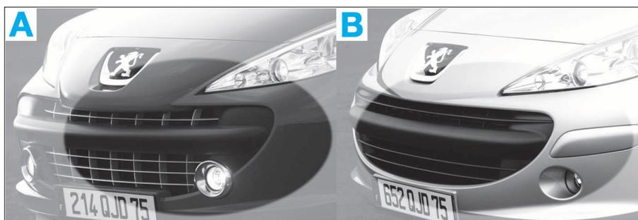
Le bouclier "Sport" se différencie de la version normale, notamment par une excroissance de sa partie avant. Il est à noter que sur la version normale du bouclier, l'antibrouillard avant se dépose par l'extérieur du bouclier, tandis que sur la version "Sport", il se dépose par l'intérieur.
