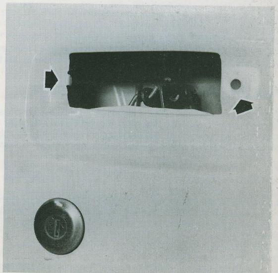
La poignée d'ouverture de porte n'est fixée que par une seule vis, par contre elle est emboîtée sur la partie arrière qui dispose d'un ergot d'arrêt.
