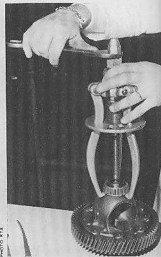
Extraction d'un roulement du boîtier de différentiel.
