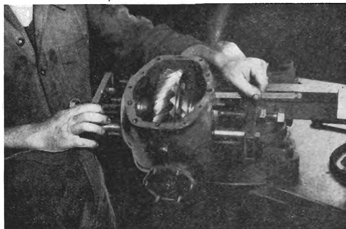
Fig. 7. — Après réglage du jeu latéral le dépassement doit être le même des deux côtés.
