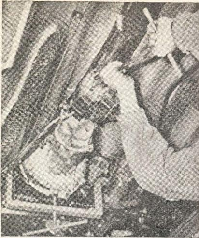
Dévisser les quatre vis d'assemblage du couvercle de rotule de poussée
