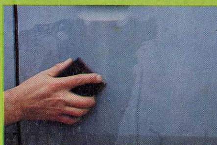
9. Poncer à l'eau au papier n° P 800/P 1.000. Rincer et sécher.
