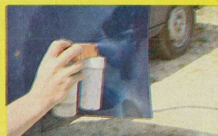
9. Passer un tampon d'essuyage sur la surface à peindre pour enlever les dernières poussières. Appliquer d'abord un voile de laque, puis une couche simple. Laisser sécher 5 minutes et terminer par une couche croisée.
