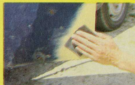
6. Poncer à l'eau au papier n° P 800/P 1.000. Rincer à l'eau claire et sécher.
