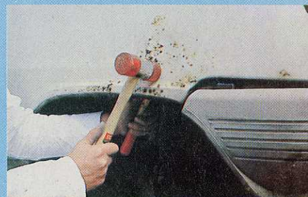
1. Redresser la tôle à l'aide d'un maillet.
