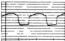
Court-circuit d'une diode excitatrice
