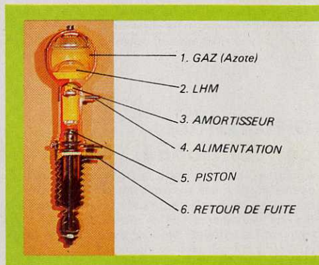
SUSPENSION HYDROPNEUMATIQUE (DOC. CITROEN)
