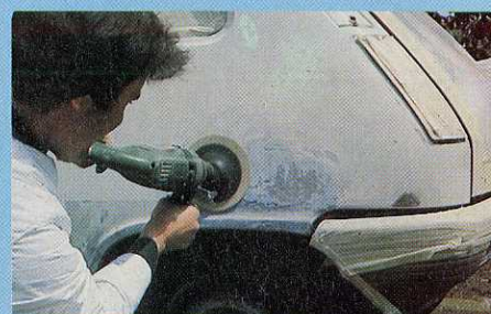
4. Dégrossir le ponçage au disque n° P 60.
