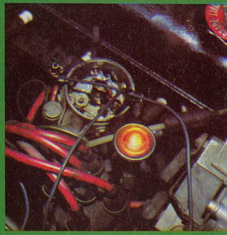
REGLAGE STATIQUE AVEC UNE LAMPE TEMOIN (CLICHE E.A.)
