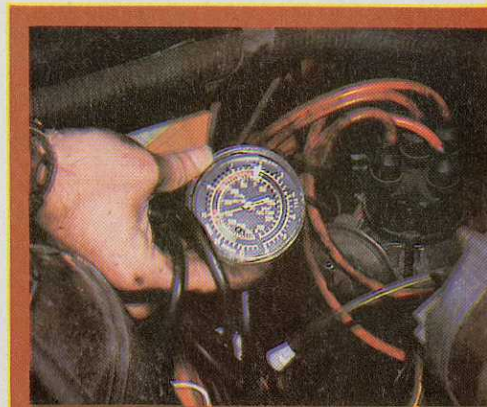
CONTROLE DE LA DEPRESSION DU MOTEUR (CLICHE E.A.).
