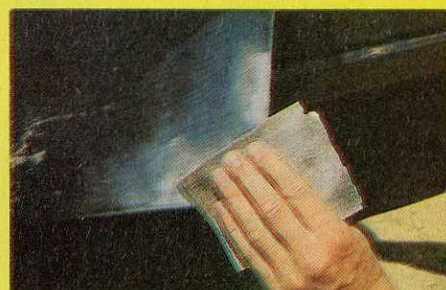
3. Dégrossir le ponçage au papier n° P 60.
