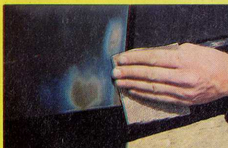
1. Poncer au papier n° P 36 pour éliminer toutes traces de rouille et mettre la tôle à nue.
