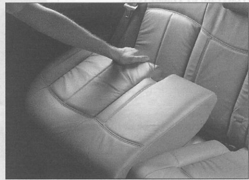
Déverrouillage de l'assise de la banquette arrière.
