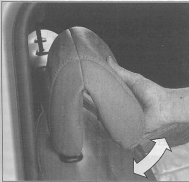
Réglage de l'inclinaison de l'appui-tête.
