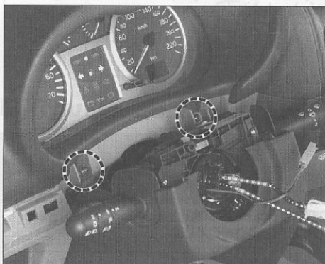
Implantation des vis de fixation du combiné d'instruments et du revêtement supérieur de planche de bord.
