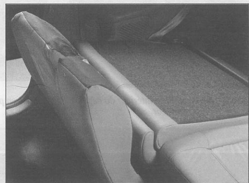
Déverrouillage du dossier de la banquette arrière.
