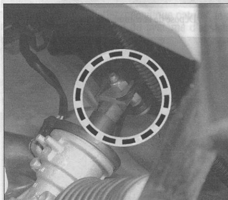
Implantation du boulon de fixation du cardan.
