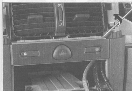
Dépose du support interrupteurs.
