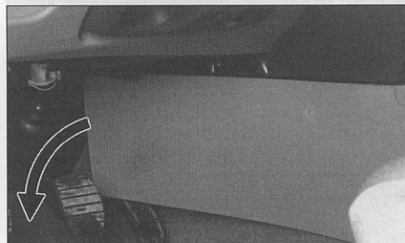
Dépose de la console centrale.
