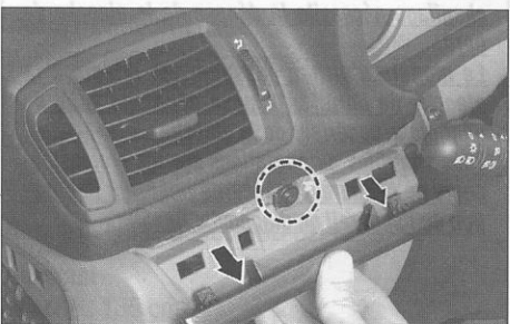
Dépose du cache gauche.
