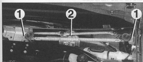
Dépose du mécanisme d'essuie-glace avant.
