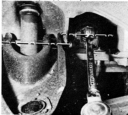
Positionnement des biellettes dans un plan horizontal (parallèle à l'axe d'articulation du bras supérieur) (Photo RTA)
