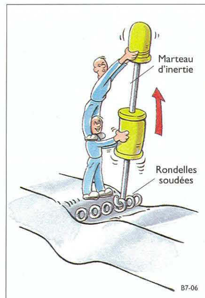
Débosselage d'une tôle en exerçant une traction à l'aide d'un marteau d'inertie sur des rondelles soudées.
