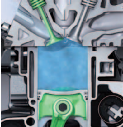
phase d'admission dans le mode du cycle de Budack
