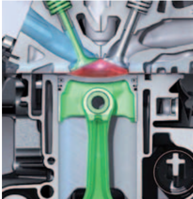
phase d'expansion dans le mode du cycle de Budack
