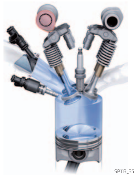
image du cylindre à charge pleine du moteur (moteur en mode de carburation à charge pleine)
