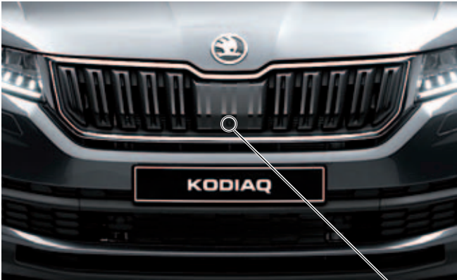
SP114_12 caméra frontale dans la calandre avant
