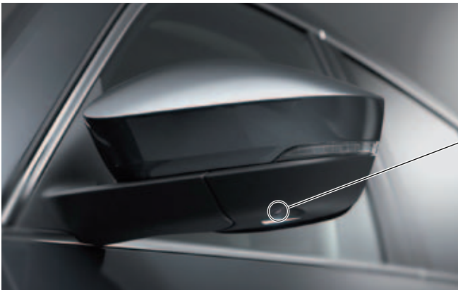
caméra latérale dans le rétroviseur droit
