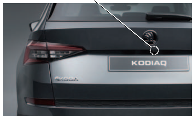
caméra arrière dans la poignée du hayon
