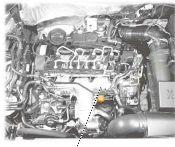
Vanne de commutation du radiateur de recyclage des gaz d'échappement N345
