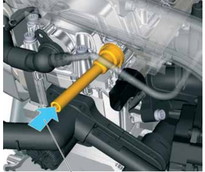
Arrivée d'air venant du filtre à air
