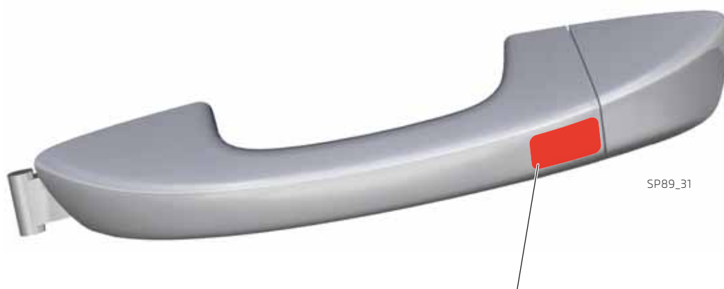
Position du capteur capacitif pour le verrouillage du véhicule
