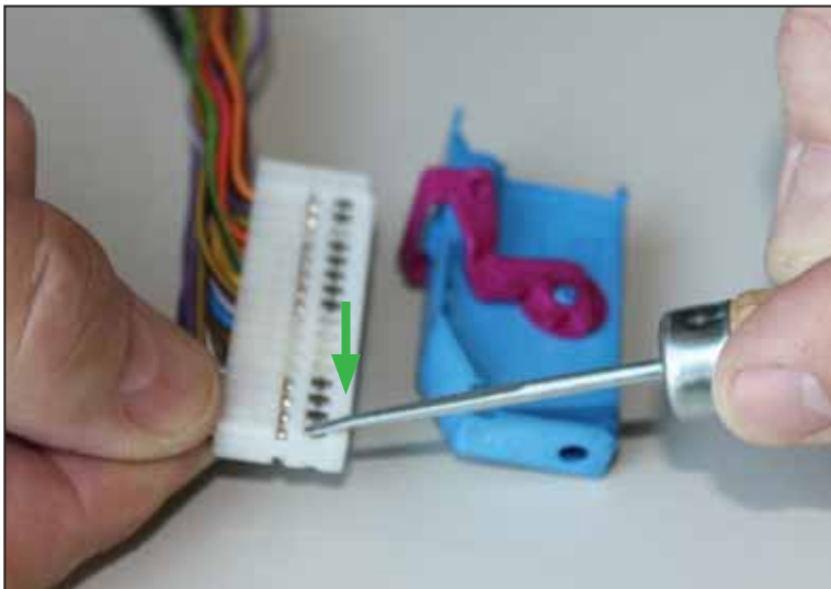
Déblocage de la fiche de raccordement avec l'outil prescrit
