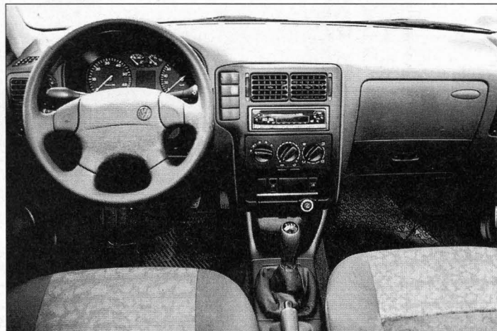
Intérieurement on peut noter l'apparition de l'airbag passager et au millésime 98 d'un nouveau combiné d'instruments regroupant les cadrans et voyants en son centre.
