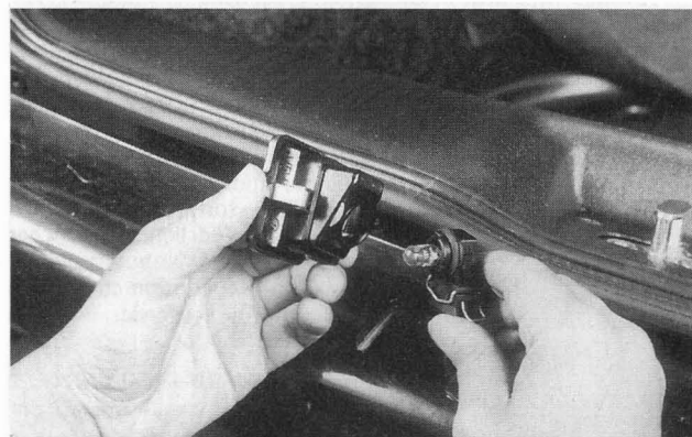
Remplacement d'une lampe de plaque de police.
