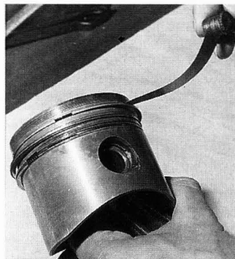
Contrôle du jeu des segments dans leurs gorges.
