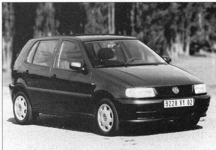
Extérieurement les Polo Match II Confort se distingue des versions Match II par les gros boucliers type sport, des clignotants blancs et de nouveaux enjoliveurs.
